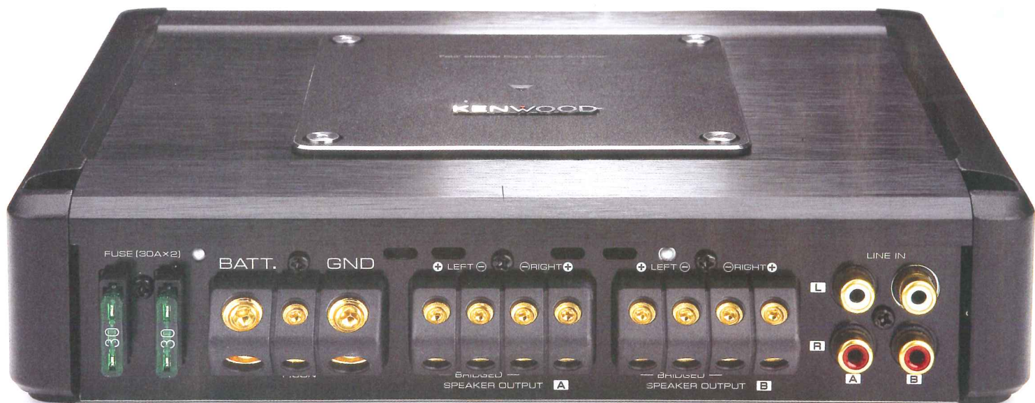
L'affollato lato connessioni vede una coppia di fusibili da 30 A cadauno, seguono i connettori di alimentazione e quelli per gli altoparlanti che accettano tutti cavi di notevole sezione. Infine i quattro ingressi pre di qualità non elevatissima.
